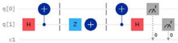
Figura 7. Ejemplo de circuito del protocolo de codificación superdensa
